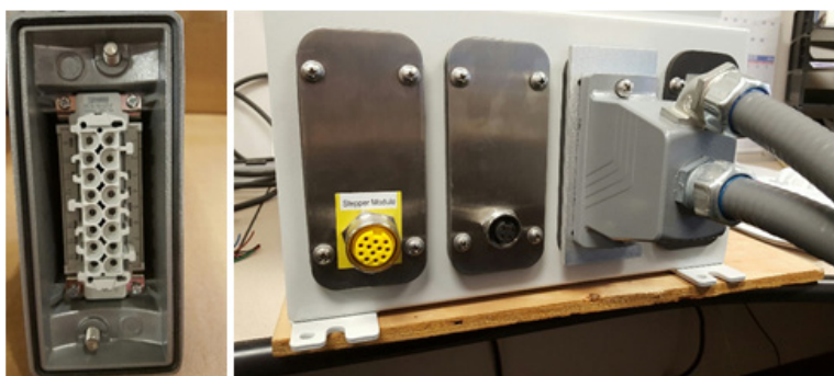
Figura 1.8.4-5 Centro de terminación de cables
