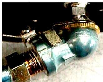
Figura 1.6.4-6 Válvula de llenado con conector Schrader.
